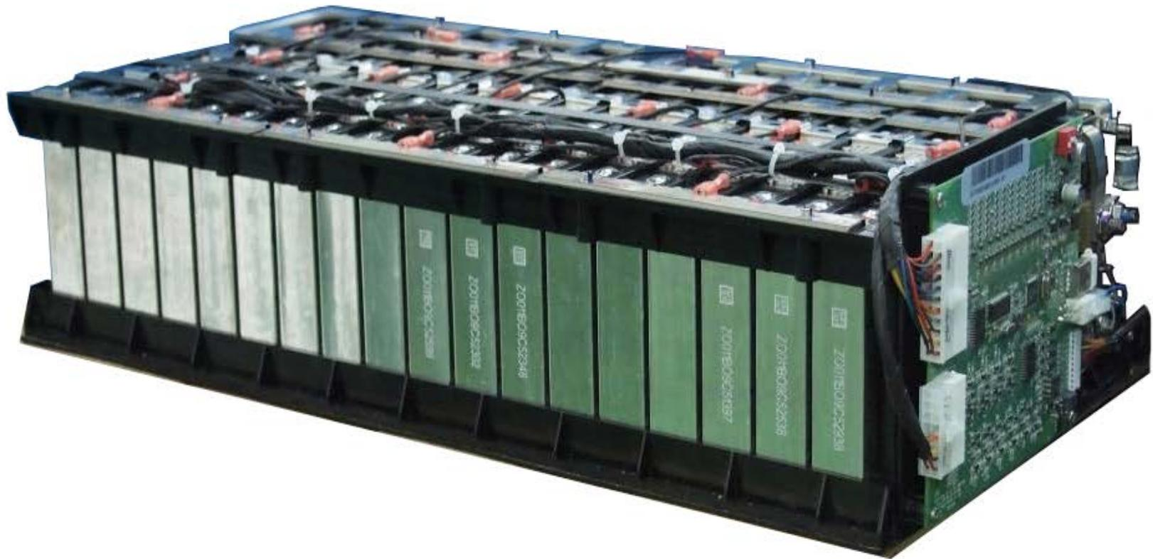
BMS應用中主控器可透過AEN1964讀取各節電池電壓
