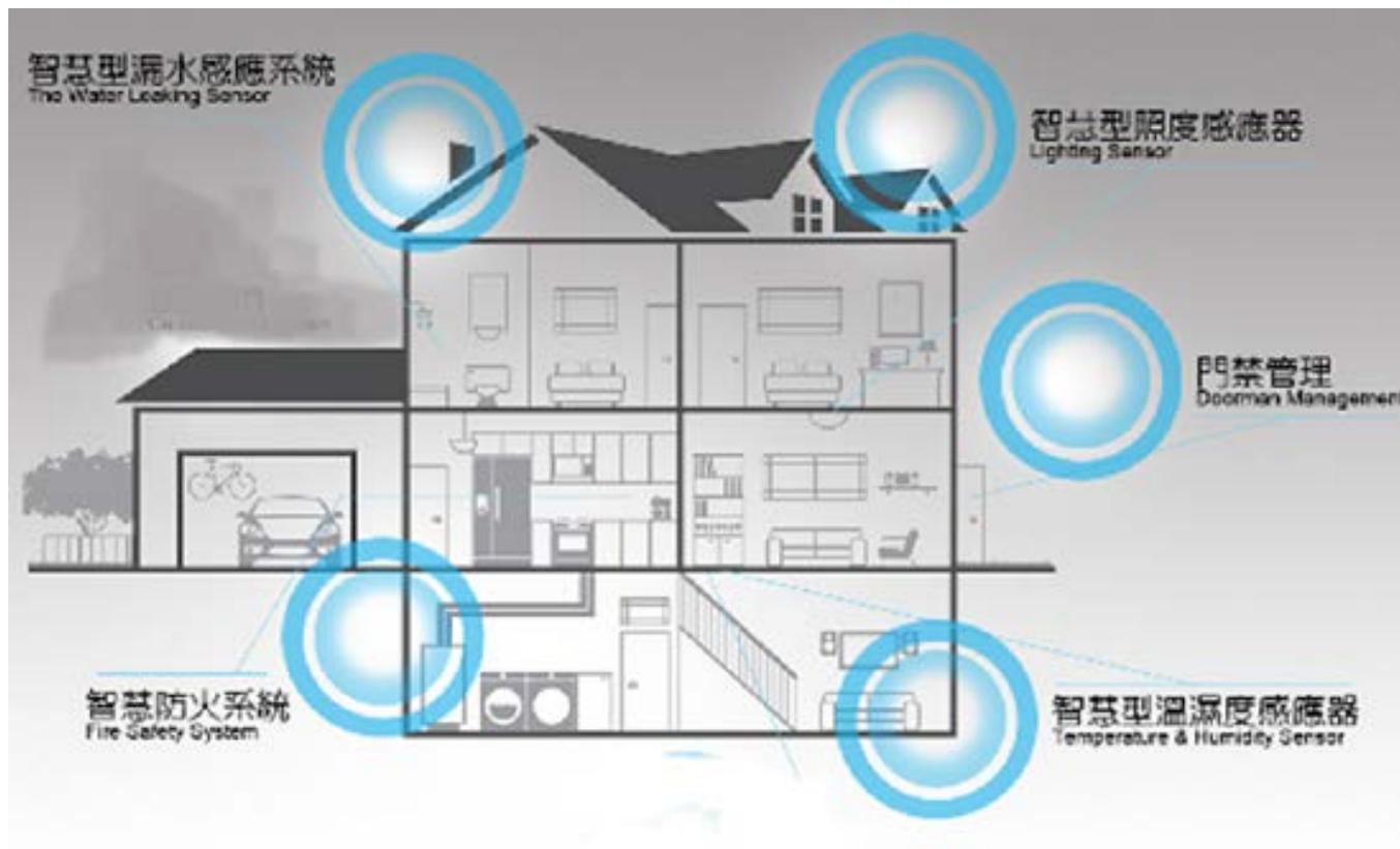
漏水感應，照度，防火，濕度感應皆可透過三條傳輸線並接連接到主控器，主控器也可透過同樣的三條傳輸控制門禁，減抵配線困擾
